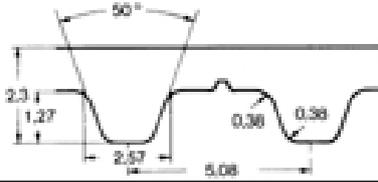
**Courroie dentée PU ZRP XL K 210/025**
